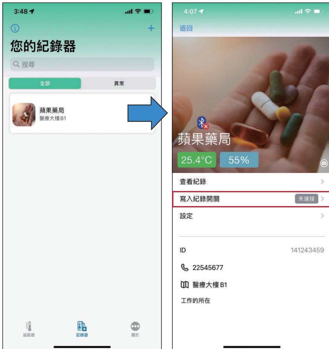
(2) 可依照需要，先調整每筆紀錄間隔時間 (10秒-10小時)，設備將自動計算，覆蓋天數。每筆間隔越長，循環天數越長。
